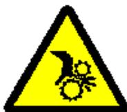
機台內部有會移動的機械傳動區。勿隨意將手或手指伸入 Panel 內。會有手或手指被傳動中的齒輪(Gear)或傳送帶夾入的意外。維修作業時，請先將關閉機台和配電盤的斷路器後，再進行作業。
