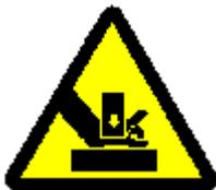
機台內部有會移動的機械傳動區。勿隨意將手或手指伸入 Panel 內。會有手或手指被傳動中的機構夾入的意外。維修作業時，請先將關閉機台和配電盤的斷路器後，再進行作業。
