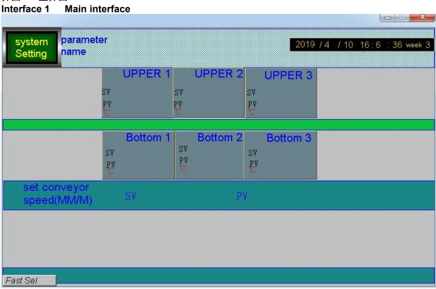
SV: 设定速度值 PV: 实际速度值
