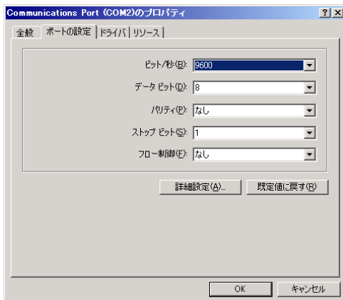
図 17. UPS 装置に対するシリアルポートの設定例
